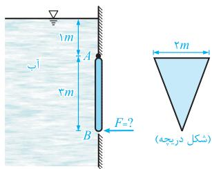
● **مسئله ۹:** برای یافتن نیروی  $F$ ، دیاگرام جسم آزاد دریچه را در نظر گرفته و نیروهای وارد بر آن را روی شکل نشان می‌دهیم. در این حالت نیروی هیدرواستاتیکی را به صورت نیروی هیدرواستاتیک  $F$  روی مرکز سطح دریچه وارد کرده و اثر لنگر ناشی از این انتقال را نیز به صورت  $M_G$  لحاظ می‌کنیم.
