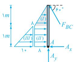
همچنین دیاگرام جسم آزاد دریچه را به صورت مقابله رسم کرده و نیروی  $F_{BC}$  را نیز روی آن نشان می دهیم. توجه داشته باشید که منشور فشار ذوزنقه ای در قسمت پایینی دریچه (قسمتی که در تماس با آب است) را به یک مثلث و یک مستطیل تفکیک نموده ایم.
