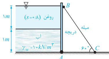
**تمرین ۱۵:** برای نگهداشتن دو لایه روغن و آب به ارتفاع های ۱، از دریچه  $AB$  و میله  $BC$  مطابق شکل استفاده شده است. در این صورت نیروی ایجاد شده در میله  $BC$  چند  $kN$  است؟ (عرض دریچه یک متر است)
