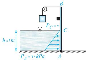
(الف) از آنجاکه دریچه نشان داده شده در شکل، مستطیلی است (با ارتفاع  $h$  و عرض  $2m$  عمود بر صفحه شکل)، بنابراین برای محاسبه نیروی هیدرواستاتیک وارد بر می‌توان از روش منشور فشار استفاده کرد. برای این کار ابتدا باید منشور فشار (یا همان توزیع فشار) وارد بر دریچه (صفحه مستطیلی) را با یافتن فشار در نقاط بالا و پایین دریچه، بهصورت مقابل ترسیم می‌کنیم.
