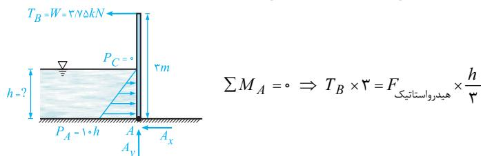
در رابطه بالا،  $\frac{h}{3}$  فاصله مرکز حجم منشور فشار مثلثی رسم شده ( محل اثر نیروی هیدرواستاتیک ) تا محل لنگرگیری یعنی  $A$  می‌باشد. حال در ادامه با جایگذاری مقادیر  $T_B$  و  $F$  هیدرواستاتیک در رابطه  $\sum M_A = 0$ ، مقدار  $h$  را می‌یابیم:
