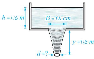
۱۶- در شکل زیر قطر جت خارج شده از روزنہ در فاصله  $1/5$  متری از کف مخزن تقریباً چقدر است؟ قطر روزنہ تعییه شده در کف مخزن  $28\text{ cm}$  است و از تلفات صرف‌نظر شده است. ( $\sqrt{2} \approx 1/4$ )
