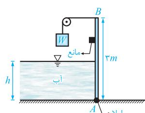
**تمرین ۱۳:** دریچه  $AB$  با طول عمود بر صفحه  $2m$  توسط وزن  $W$  با وزن  $3/75 kN$  بسته نگهداشته شده است. در این صورت با فرض
