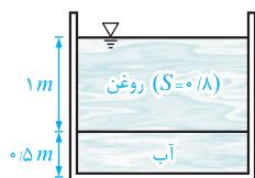
**تمرین ۸:** مخزن شکل مقابل که محتوی آب و روغن است، دارای قاعده‌ای مربعی به ضلع ۲م می‌باشد. نیروی وارد بر دیواره قائم این مخزن را تعیین نمایید.
