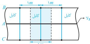
پس گزینه (۳) پاسخ صحیح این تست است. دقت شود که در این مسئله سطح پوشش هر کابل به گونه‌ای است که بعد عمود بر صفحه آن برابر ۱ متر می‌باشد. برای درک بهتر این موضوع از بالا به مخزن موردنظر نگاه می‌کنیم که شکل آن به صورت مقابل است.
