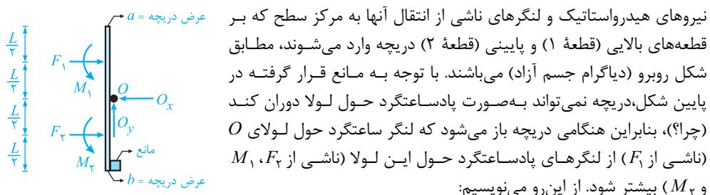
نیروهای هیدرواستاتیک و لنگرهای ناشی از انتقال آنها به مرکز سطح که بر قطعه‌های بالایی (قطعه ۱) و پایینی (قطعه ۲) دریچه وارد می‌شوند، مطابق شکل روی رو (دیاگرام جسم آزاد) می‌باشند. با توجه به مانع قرار گرفته در پایین شکل، دریچه نمی‌تواند به صورت پاد ساعتگرد حول لولا دوران کند (چرا؟)، بنابراین هنگامی دریچه باز می‌شود که لنگر ساعتگرد حول لولا  $O$  (ناشی از  $F_1$ ) از لگرهای پاد ساعتگرد حول این لولا (ناشی از  $F_2$ ،  $M_1$  و  $M_2$ ) بیشتر شود. از این رو می‌نویسیم:
