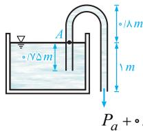
۱۷- مایعی در سیفون نشان داده شده در شکل، جریان دارد. با صرف‌نظر کردن از هرگونه افت انرژی در مسیر، فشار مطلق در نقطه  $A$  برابر کدام‌یک از مقادیر زیر است؟ فشار هوا در محل برابر  $P_a$  پاسکال و وزن مخصوص مایع  $\gamma$  نیوتون بر هر متر مکعب است. قطر سیفون ثابت است. (سراسری - ۸۱۳)
