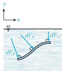
شکل رویرو یک سطح منحنی را نشان می‌دهد که جزء نیروهای عمودی فشار ( $dF$ )، در برخی نقاط آن مشخص شده‌اند. همانطور که می‌بینید چون جهت  $dF$ ‌ها در نقاط مختلف سطح منحنی متفاوت است، بنابراین نمی‌توان آنها را به سادگی جمع نموده و کل را به دست آورد.
