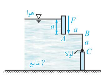
**حل:** دریچه  $ABC$  از دو قسمت  $AB$  (افقی  $\theta = 0^\circ$ ) و  $BC$  (قائم  $\theta = 90^\circ$ ) تشکیل شده است. با ترسیم دیاگرام جسم آزاد دریچه و مشخص کردن نیروها و لنگرهای وارد بر هر قسمت از این دریچه خواهیم داشت:
