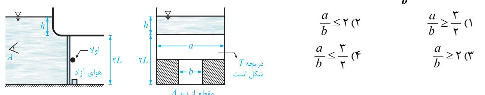
**هـ:** لنگر ناشی از نیروهای هیدرواستاتیکی وارد بر دریچه حول لولا، باعث باز شدن دریچه می‌شود. بنابراین علاوه بر مقدار نیروهای هیدرواستاتیک، محل اثر آنها (جهت محاسبه لنگر حول لولا) نیز مورد نیاز می‌باشد. از طرفی دریچه داده شده، از دو قطعه مستطیلی (با عرض‌های  $a$  و  $b$  و ارتفاع‌های مساوی  $L$ ) تشکیل شده است، لذا می‌توان از هر دو روش فرمول و منشور فشار، مسئله را حل کرد.
