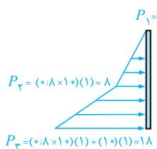
● **هل:** از آنجاکه دریچه در تماس با دو نوع سیال مختلف است، بایستی برای هر لایه یک منشور مجزا رسم شود. در ادامه با به دست آوردن مقادیر فشار در بالا و پایین لایه های سیال، این منشورهای فشار به صورت مقابله قابل ترسیم می باشند:
