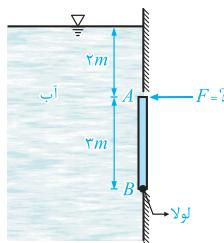
● هل: مشابه با تمرین قبل, در اینجا نیز منشور فشار وارد بر دریچه را رسم کرده و برای یافتن  $F$  از رابطه تعادل  $\sum M_B = 0$  استفاده می‌کنیم. توجه کنید که چون منشور فشار به شکل ذوزنقه است, بایستی طبق مطالعه گفته شده, آن را به یک مثلث و یک مستطیل تفکیک نماییم.
