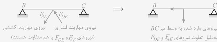
شکل ۳۰: تأثیر نیروهای نامتعادل کننده مهاربند همگرای هشتی بر تیر
