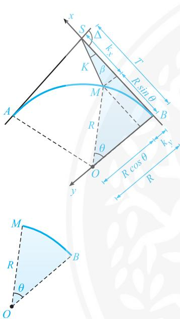
ابتدا مسیر خروجی را محور  $x$  و راستای شعاع در نقطه انتهایی قوس را که بر مماس عمود است، محور  $y$  در نظر می‌گیریم. برای پیدا کردن  $K$  کافی است فواصل تصویر خط  $SM$  بر روی محور  $x$  و  $y$  را تعیین کنیم تا به کمک رابطه فیثاغورث مقدار  $K$  تعیین گردد.
