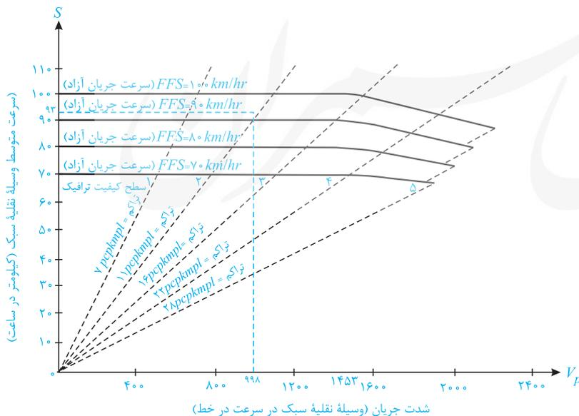
$\left\{ \begin{array}{l} \text{سرعت جریان آزاد} = 93 \text{ km/hr} \\ \text{شدت جریان} = 998 \text{ pcu/hr} \end{array} \right.$
