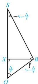
$$\frac{R}{OS} = \frac{OX}{R} \xrightarrow{\substack{\text{نسبت اضلاع روبه‌رو به زاویه } \frac{\Delta}{2} \\ \text{نسبت اضلاع روبه‌رو به زاویه } 90^\circ}} \frac{OX=I}{OS=K} \rightarrow R^2 = K \cdot I$$
