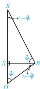
$$\frac{R}{OS} = \frac{BX}{SB} \xrightarrow{\substack{\text{نسبت اضلاع روبه‌رو به زاویه } \frac{\Delta}{2} \\ \text{نسبت اضلاع روبه‌رو به زاویه } 90^\circ}} \frac{BX=\frac{C}{2}, SB=T}{OS=K} \rightarrow \frac{R}{K} = \frac{\frac{C}{2}}{T} \Rightarrow CK = 2RT$$
