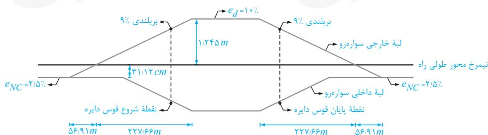
پ) برای تعیین فاصله نقطه شروع اعمال بریلندی تا نقطه انتهای قوس دایره‌ای می‌بایست به صورت زیر عمل کرد:
