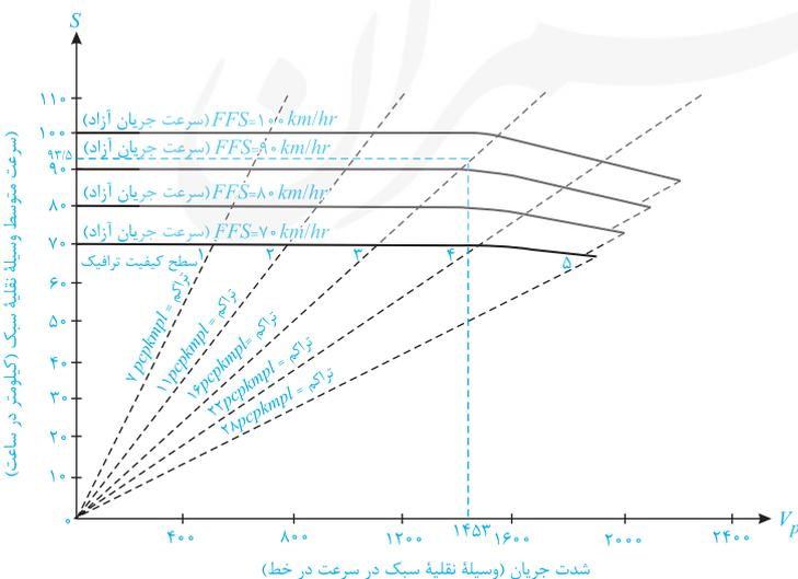
$$\begin{cases} \text{سرعت جریان آزاد} = 93.5 \text{ km/hr} \\ \text{شدت جریان} = 1453 \text{ pcu/hr} \end{cases} \Rightarrow \text{سرعت متوسط وسیله نقلیه سبک} = 93.5 \text{ km/hr}$$
