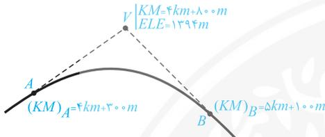
۴ الف) چنانچه در قوس سهمی قائم، طول‌های  $L_1$  و  $L_2$  با یکدیگر برابر نباشند، آن قوس نامتقارن خواهد بود. می‌دانیم که در قوس‌های سهمی نامتقارن، چنانچه خط مماسی بر نقطه نظیر قوس بر روی قوس قائم ترسیم شود قوس قائم به دو قوس سهمی قائم با مماس‌های برابر تبدیل می‌شود. پس خواهیم داشت:
