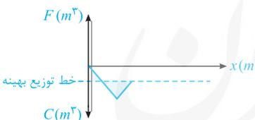
۹ در هر یک از منحنی‌های بروکنر نشان داده شده در سؤال، خط توزیع بهینه آن به صورت زیر ترسیم می‌شوند:
