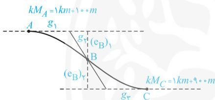
می‌دانیم که فاصله هر نقطه روی قوس تا مماس ورودی برابر با  $e_B$  می‌باشد، پس با توجه به شکل فوق می‌توان نوشت:
