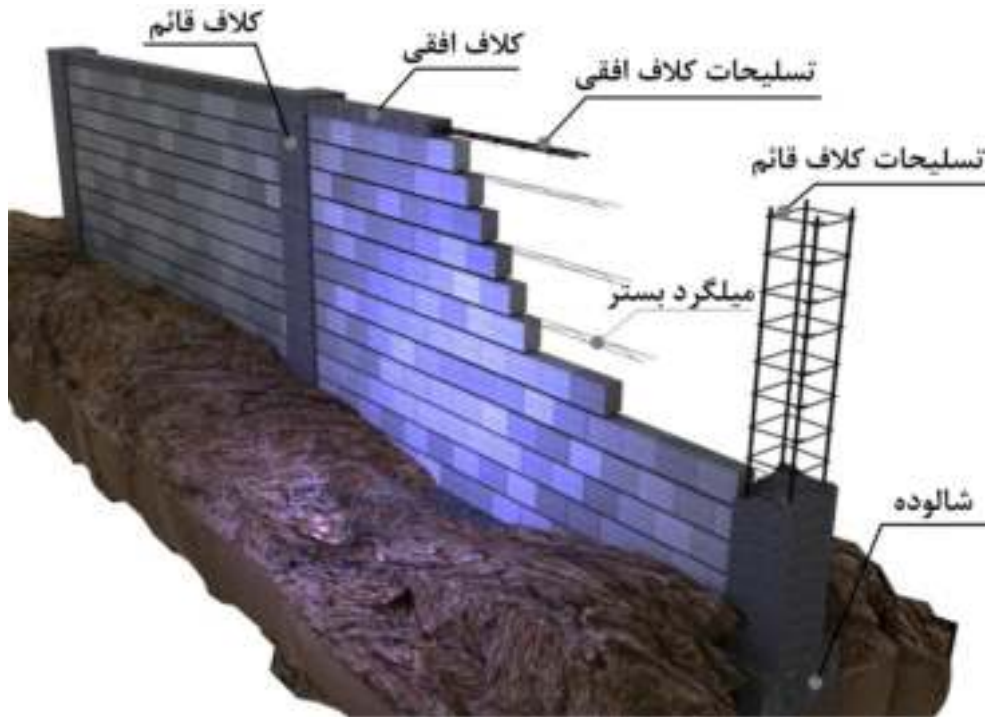
شکل ۱-۲ قسمت‌های اصلی دیوارهای محوطه بنایی
