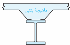
شکل: ورق‌های فولادی شکل داده شده که کنگره‌های آنها عمود بر محور تیر می‌باشد
